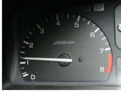
Figure 3.2 : compte-tours indiquant le régime réel du moteur
